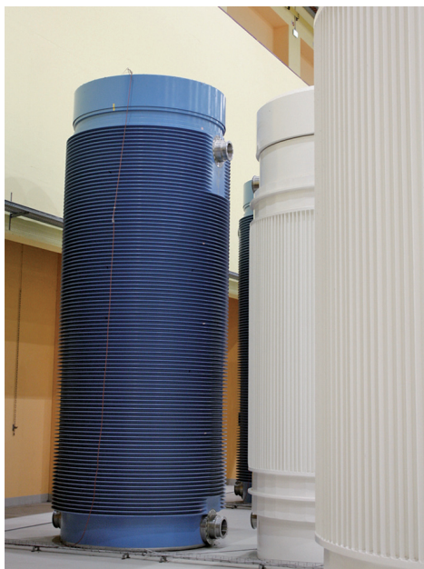
瑞士集中式中期貯存設施內所採用的玻璃固化廢棄物貯存護箱 (圖片來源: ZWILAG)
