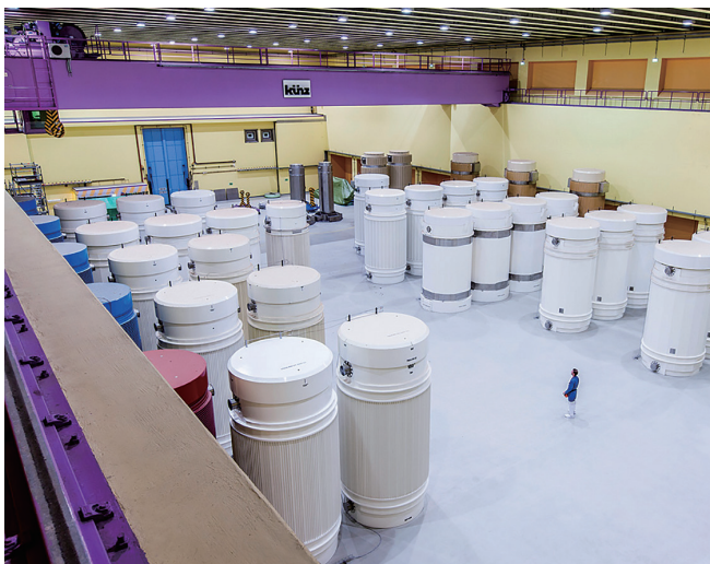
瑞士集中式中期貯存設施內的高放射性廢棄物乾式貯存廠房，用來存放來自瑞士核電廠的用過核子燃料以及因再處理所產生的玻璃固化廢棄物。(圖片來源: ZWILAG)
