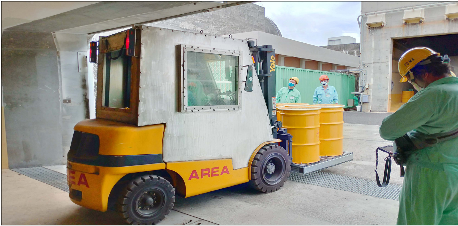
核三廠屏蔽堆高機模擬廢料桶裝載作業。
