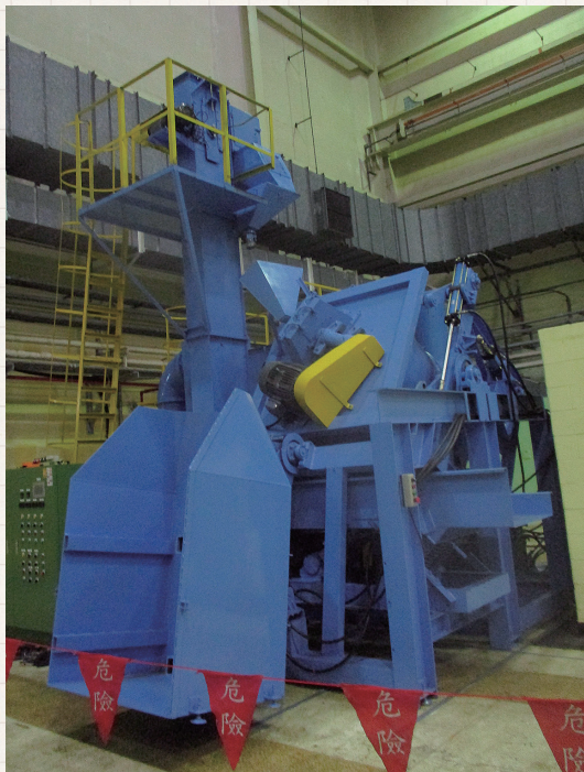
核一廠放射性廢棄物處理區域第 1 台乾式噴砂除污機 (圖片來源: 台電)
