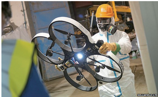
左上：建造新的屏蔽管道網絡以將液體泵出 左下：無人機可檢查對人類有危險的高輻射區域 右上：巨型機械手臂未來可用於拆除和包裝受污染的設備
