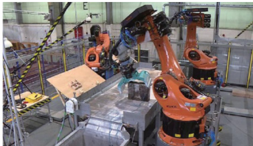
無人機可檢查高輻射區域 (圖左)，建造新屏蔽管道網路以將液體泵出 (圖中)，巨型機械手臂用於拆除和包裝受污染設備 (圖右)。
