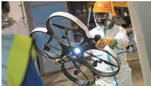
無人機可檢查高輻射區域 (圖左)，建造新屏蔽管道網路以將液體泵出 (圖中)，巨型機械手臂用於拆除和包裝受污染設備 (圖右)。
