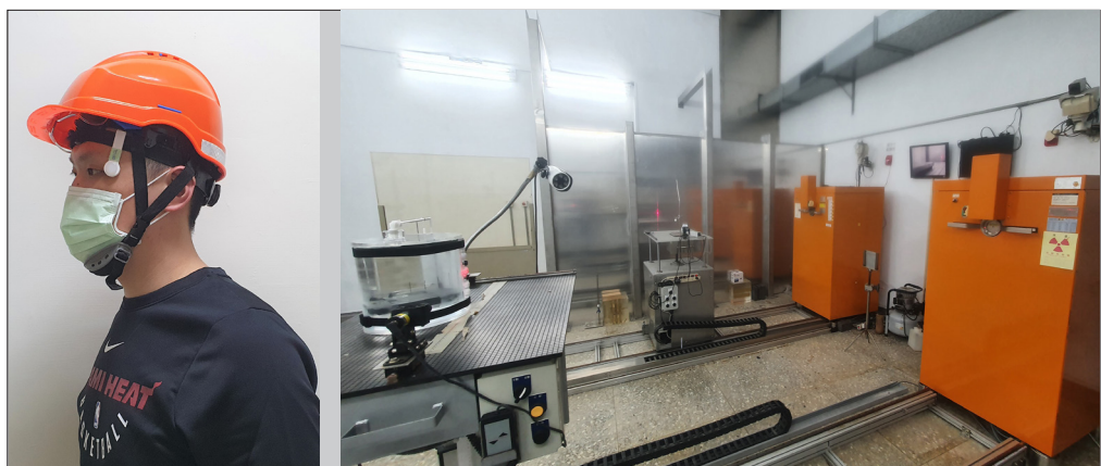
工作人員佩帶眼球劑量計 (圖左)，標準輻射場進行照射實驗 (圖右)。
